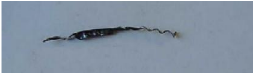
钻屑短而粗，正确
